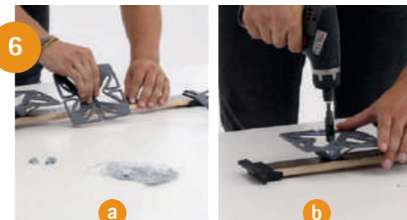
Die Federelemente aufsetzen und mit den Kreuzschrauben festschrauben. | Put on the spring elements and screw tight with the cross screws.
