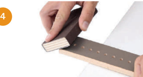
Wir empfehlen die Kanten sauber abzuschleifen. | We recommend sanding the edges clean.
