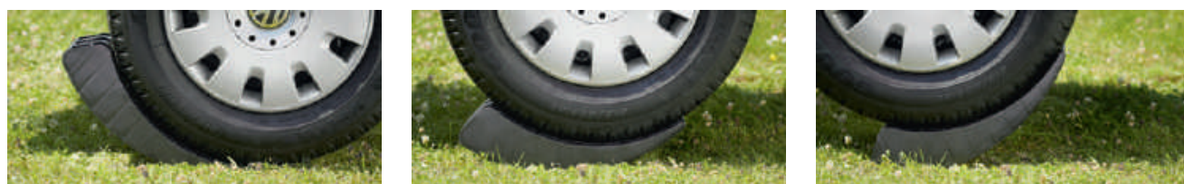
1. Keil unter dem Reifen festklemmen | 2. Stufenlos auffahren 1. Move leveller under the wheel | 2. Continuous access
