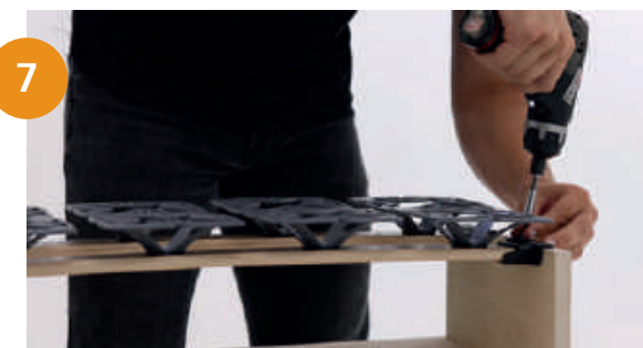
Leistenahmen im gleichmäßigen Abstand am Rahmen festschrauben. | Screw the slat holders evenly spaced to the frame.
