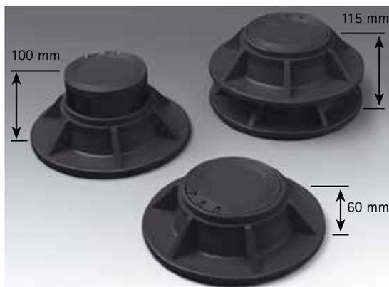
Gewährt perfekten Höhenausgleich auf unebenem Gelände. Je nach Ausgleichsbedarf lassen sich die Stützfüße durch Aufsetzen sowie Einsenken des Einsatzdeckels oder Aufeinandersetzen in der Höhe variieren.
