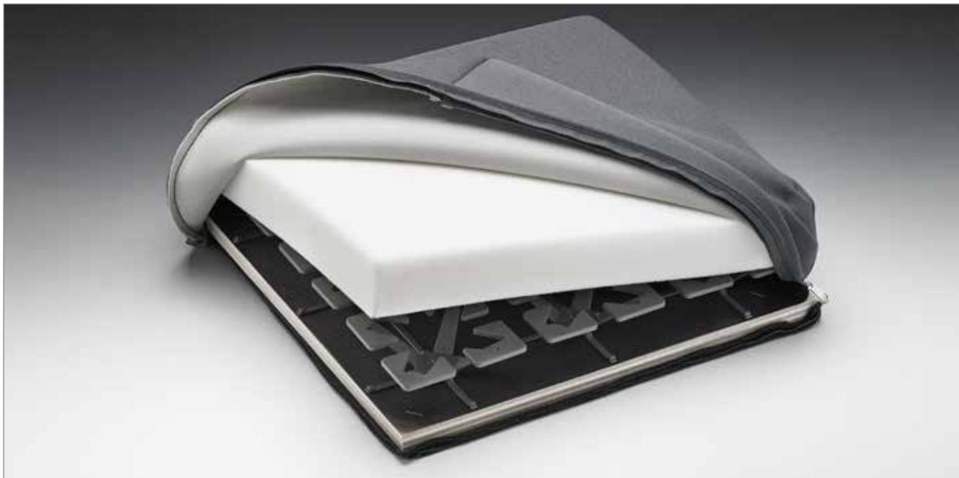
Froli Polstermodule werden individuell und montagefreundlich für Fahrzeuge entwickelt. Die Froli Federmatte wird direkt auf einer Plattenkonstruktion befestigt und mit einer hochwertigen Matratze bzw. Polsterung zu einer Einheit verbunden. Es sind geringe Aufbauhöhen und verschiedene Härtegrade möglich.
