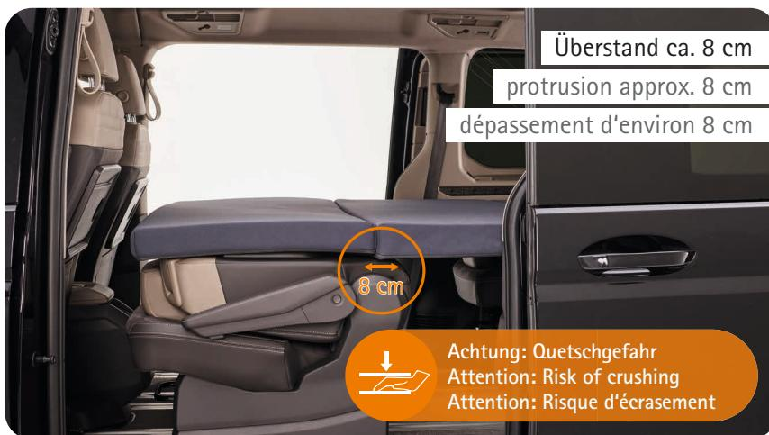
**6** Polstermodul mit zwei Spanngurten (im Lieferumfang enthalten) hinten im Fahrzeug sichern
