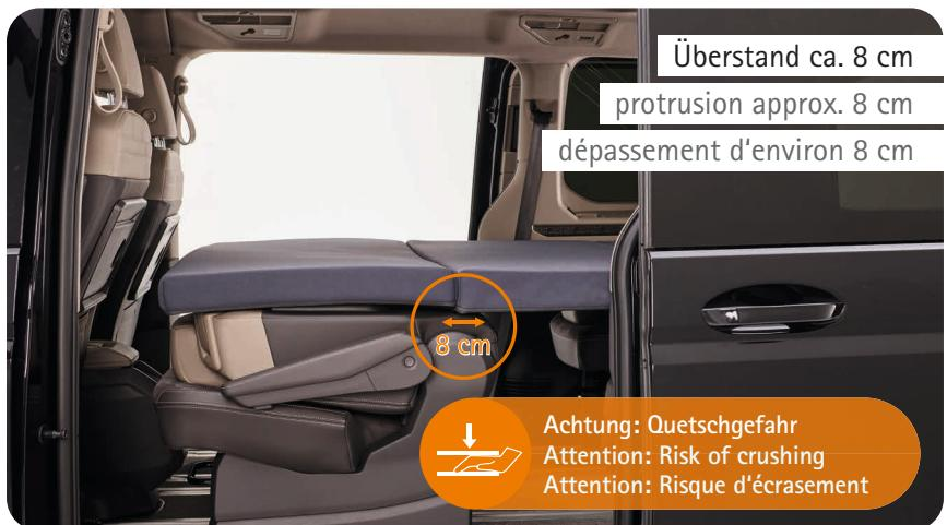
**7** Polstermodul mit drei Spanngurten (im Lieferumfang enthalten) hinten im Fahrzeug sichern
